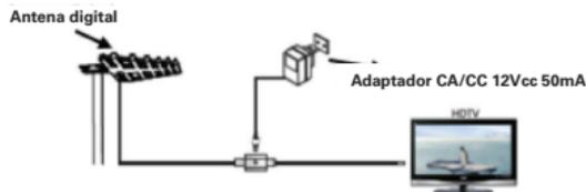
**Instalación 2: Conexión directa a Televisores de Alta Definición (HDTV)**
