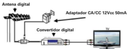
**Instalación 1: Conexión a través del convertidor digital**
